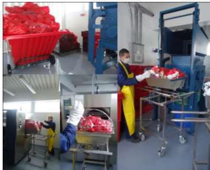
Sistema de tratamiento de residuos hospitalarios Biosanitarios: "AUTOCLAVE DE ALTA EFICIENCIA "
